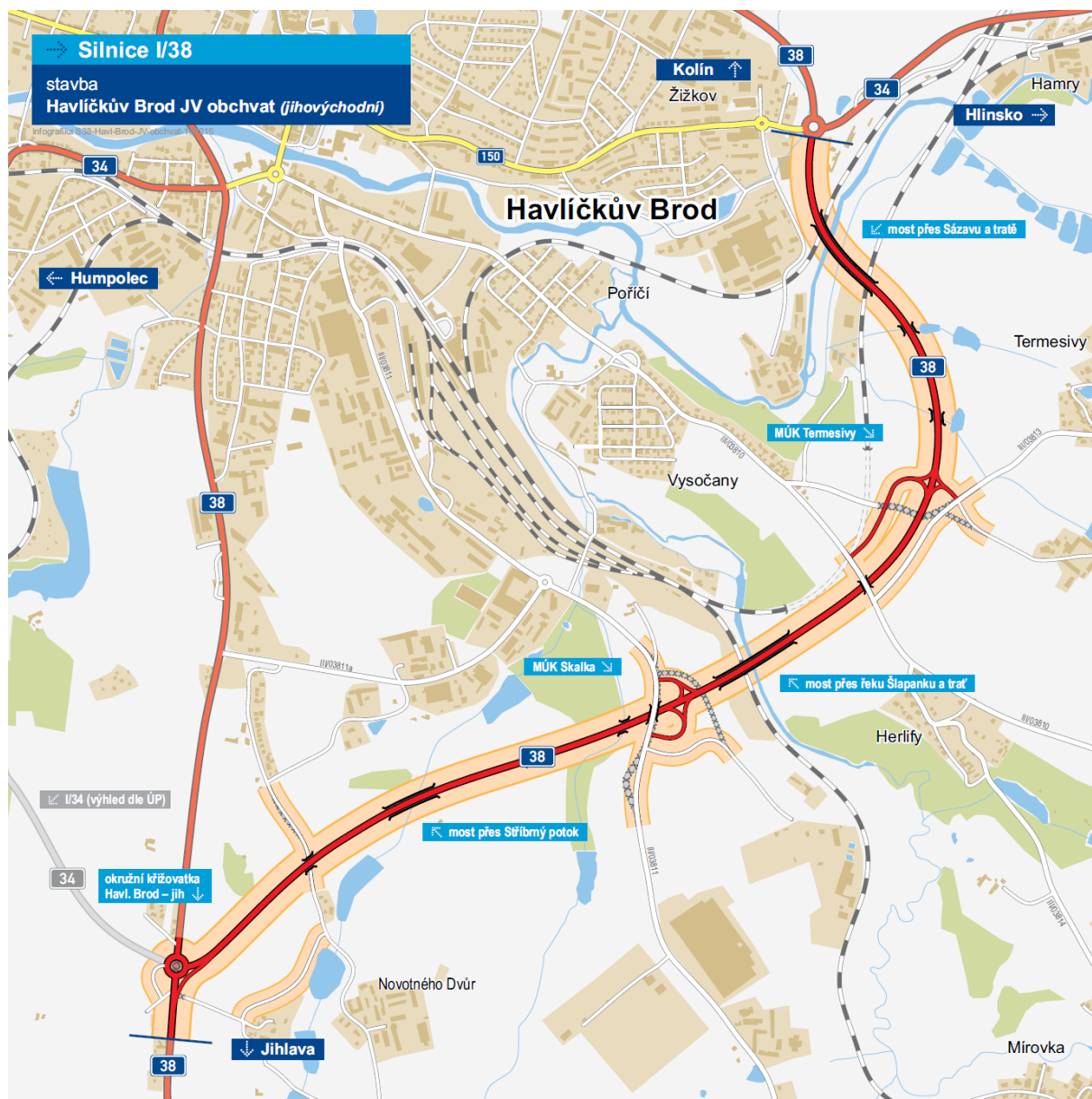
Obrázek 16 Stavba JV obchvatu v kontextu stávajícího stavu
